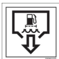
Výpust vodního kalu z palivového filtru
