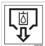
Výpust nádrže s hydraulickým olejem
