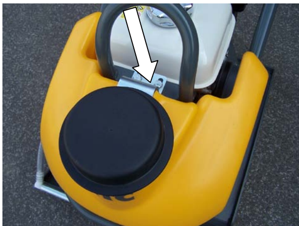
Obr. Demontáž vodní nádrže kroupení
