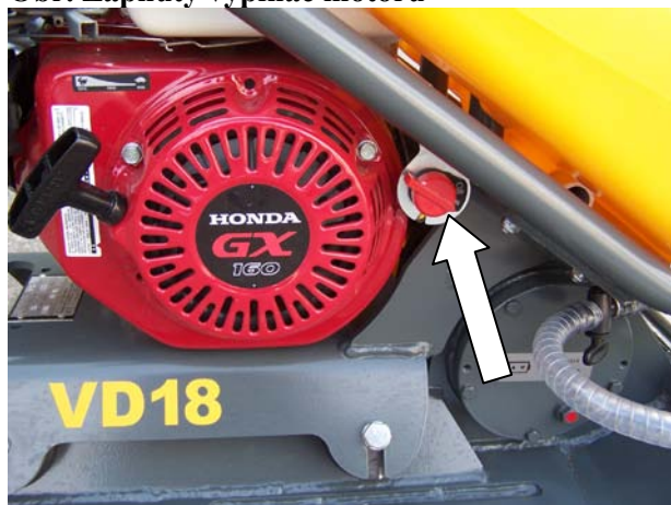
Obr. Zapnutý vypínač motoru
