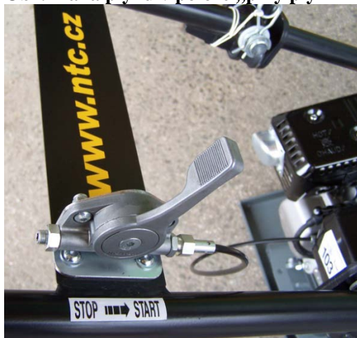
Obr. Páka plynu v poloze „plný plyn“
