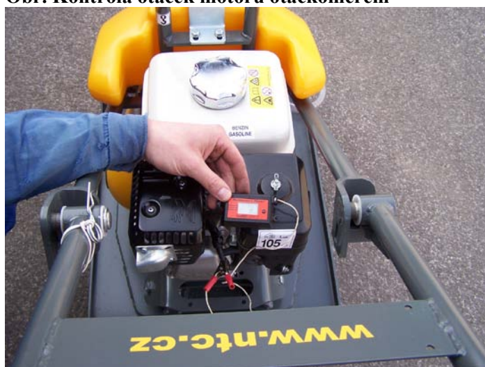
Obr. Kontrola otáček motoru otáčkoměrem
