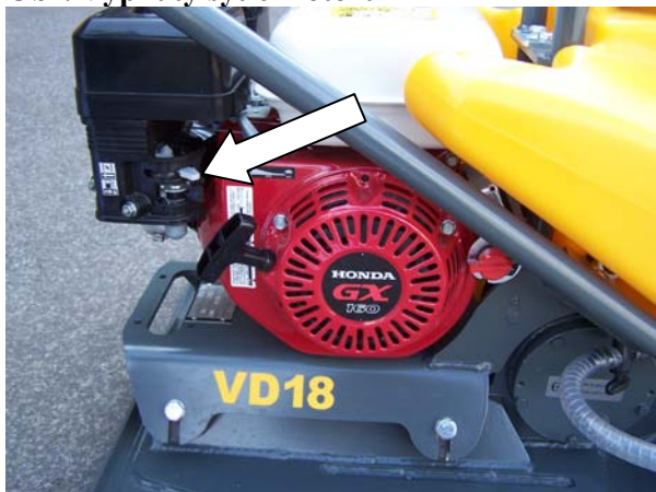
Obr. Vypnutý sytič motoru
