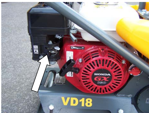
Obr. Zavřený palivový kohout motoru
