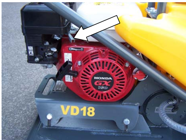
Obr. Vypnutý vypínač motoru
