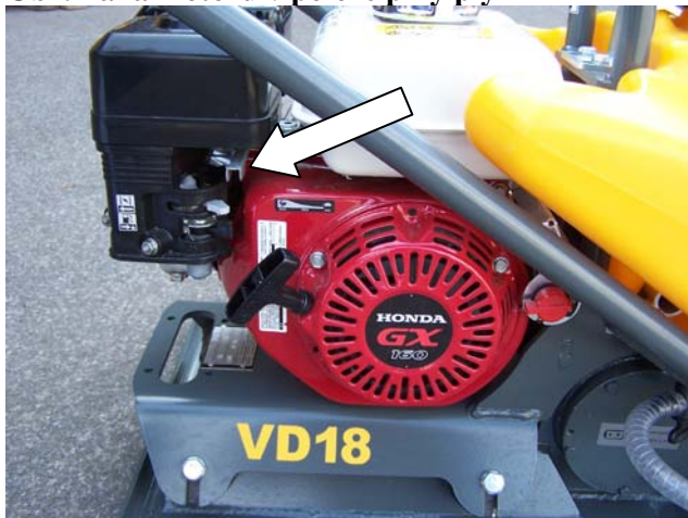
Obr. Páka motoru v poloze plný plyn
