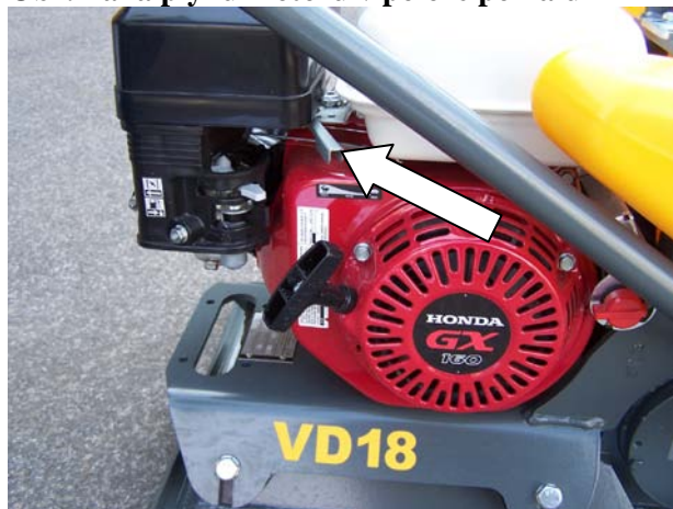
Obr. Páka plynu motoru v poloze pomalu
