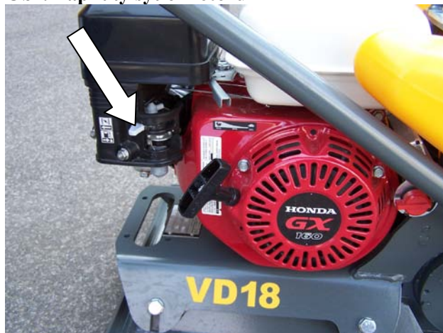
Obr. Zapnutý sytič motoru
