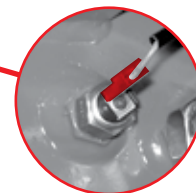
Obr. 110 Snímač teploty hydraulického oleje
