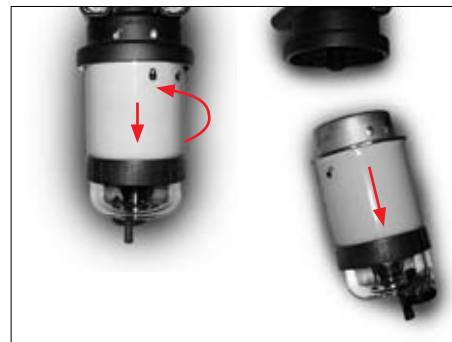
Obr. 104 Výměna palivového filtru
