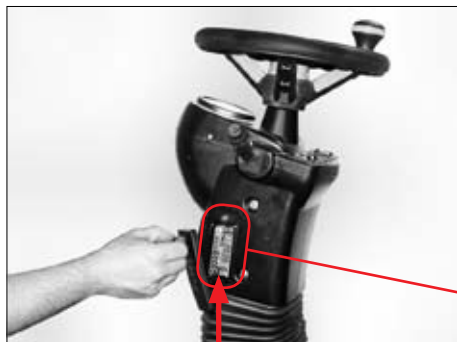
Obr. 127 Pojistková skříň
