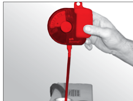
Obr. 114 Kontrola nemrznoucí směsi
