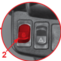
Obr. 47 Odjištění hydraulického uzávěru pro pracovní nástroje k připojení
