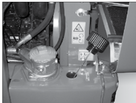
Obr. 91 Snižování zbytkového tlaku
