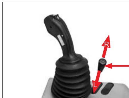
Obr. 45 Ovládací páka doplňkové hydrauliky
